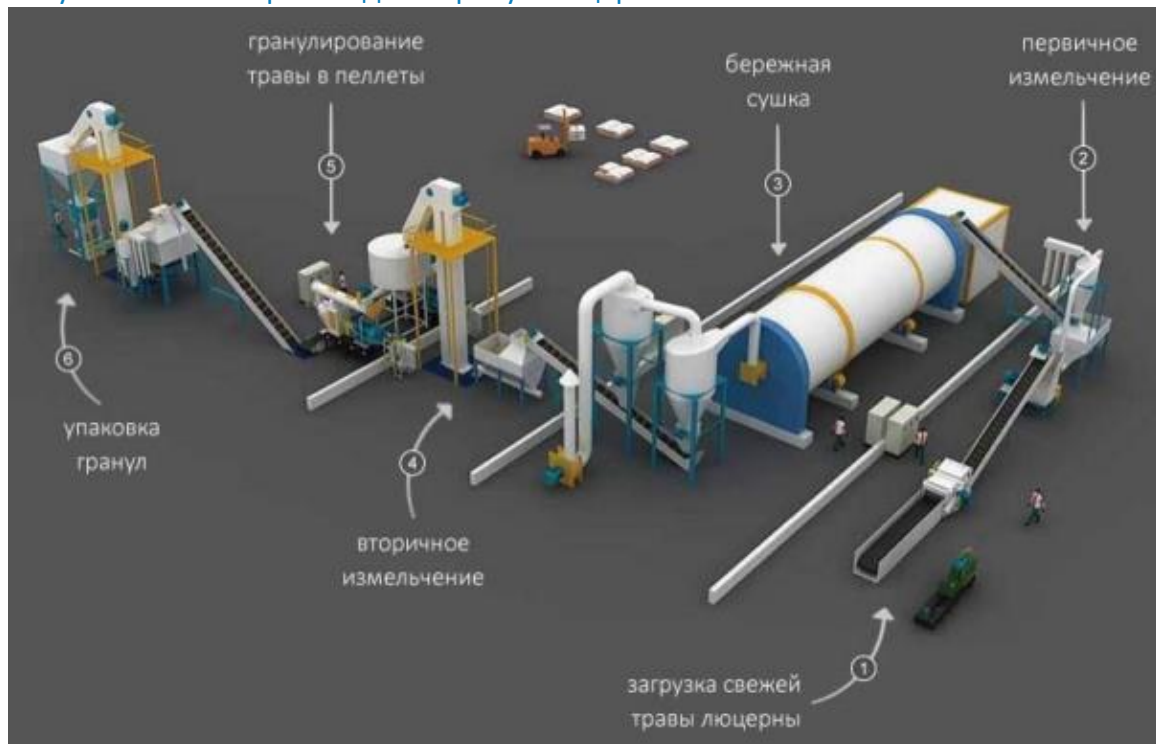
Рисунок 1. Схема производства гранул люцерны
